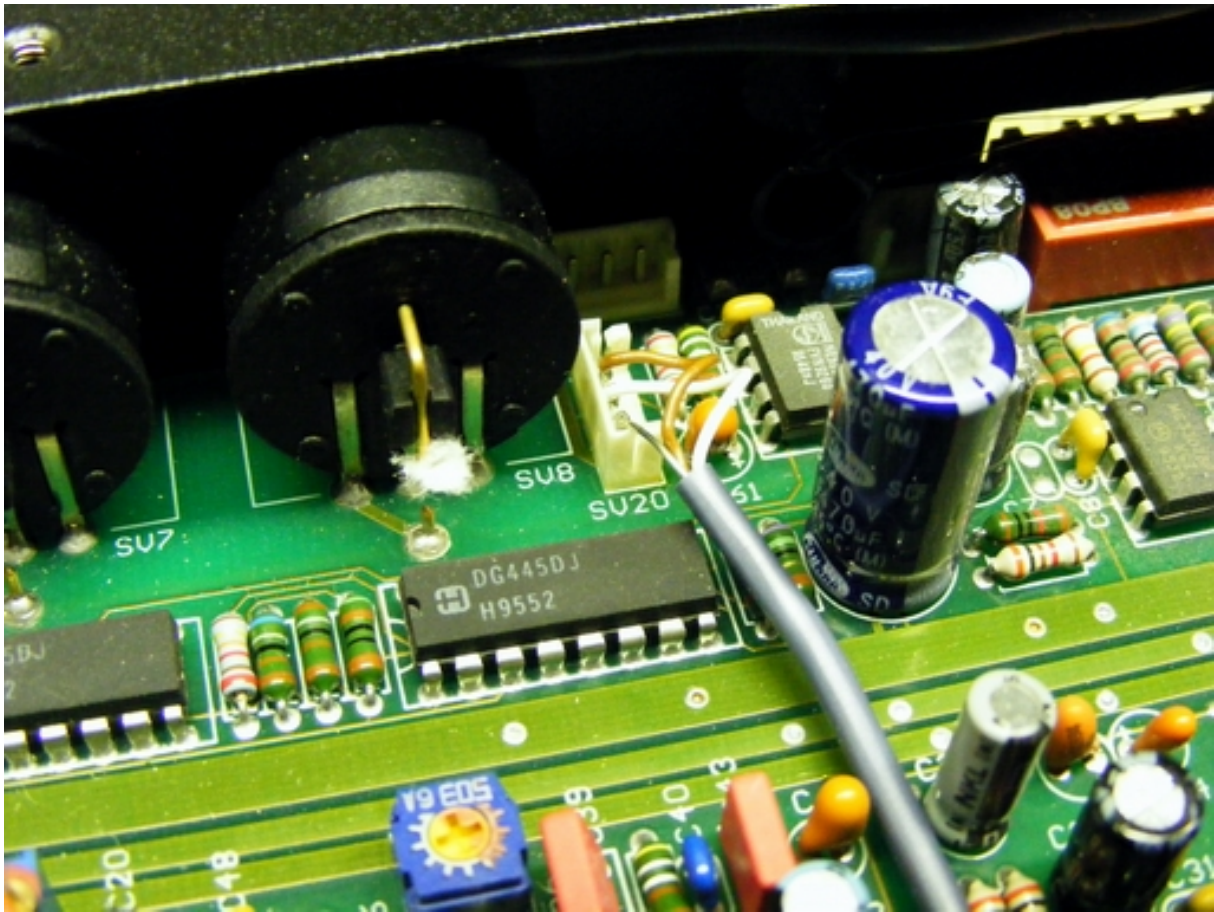
Bild: Die kommende Leitung vom Übertrager zur Leiterplatte.
