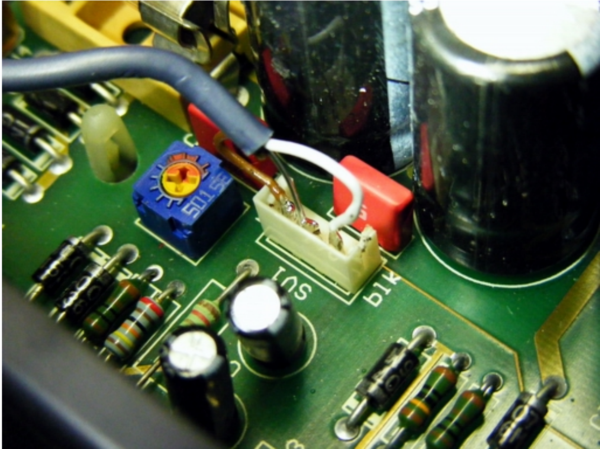
Bild: Phantomspeisung an Klemme SV1.
