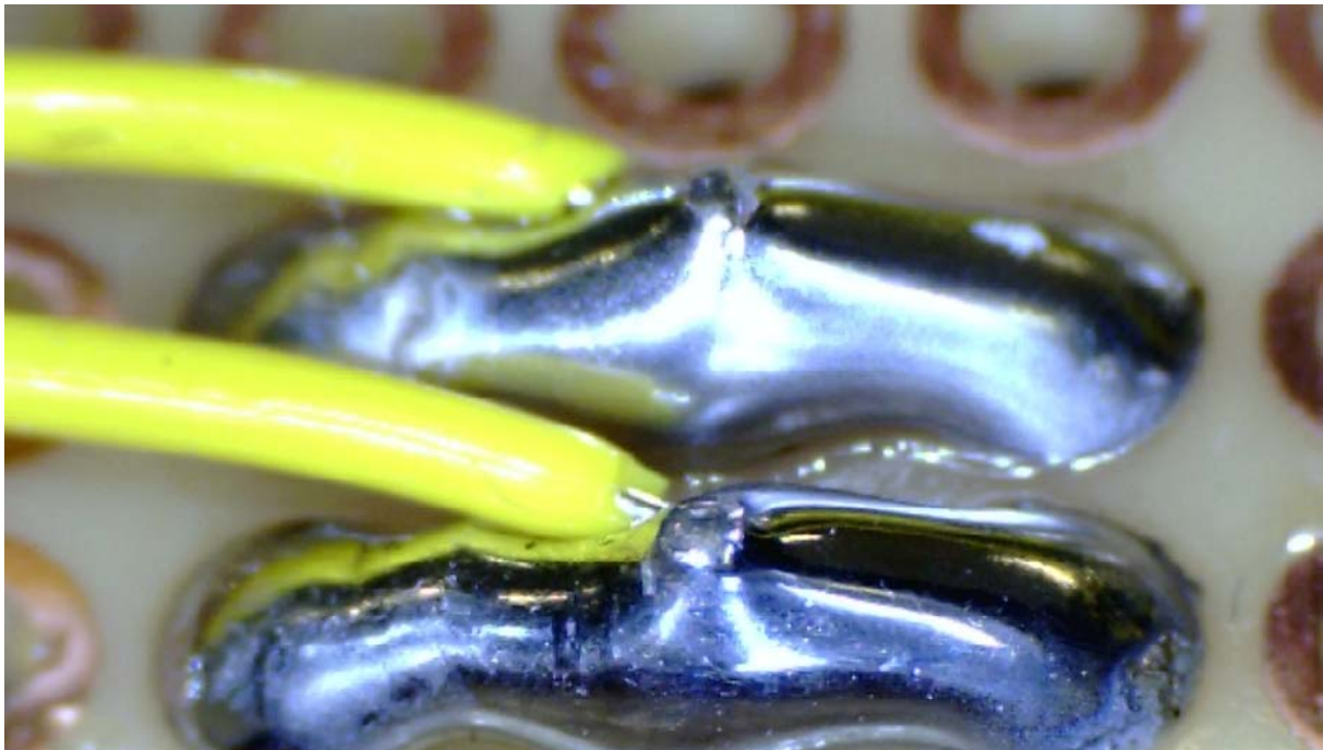
Bild: Lötstelle einer Lochrasterplatte mit Teflon Draht.
