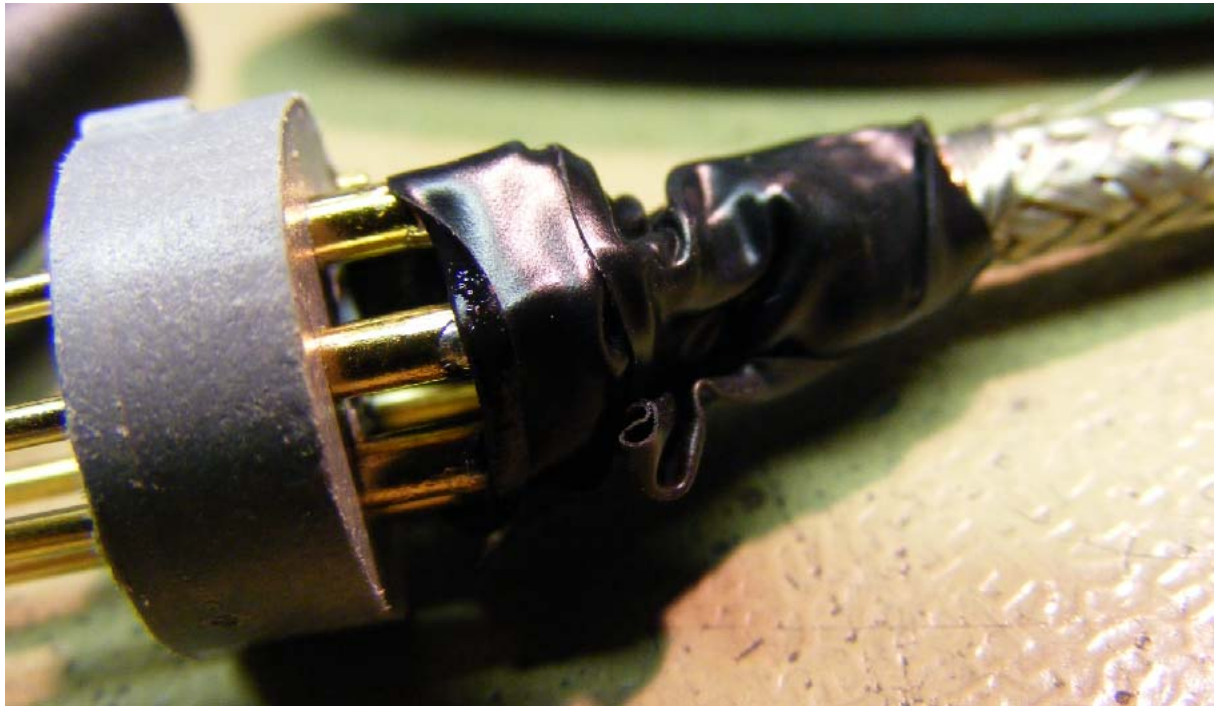
Bild: Isolation an einem mehrpoligen XLR-Stecker...
