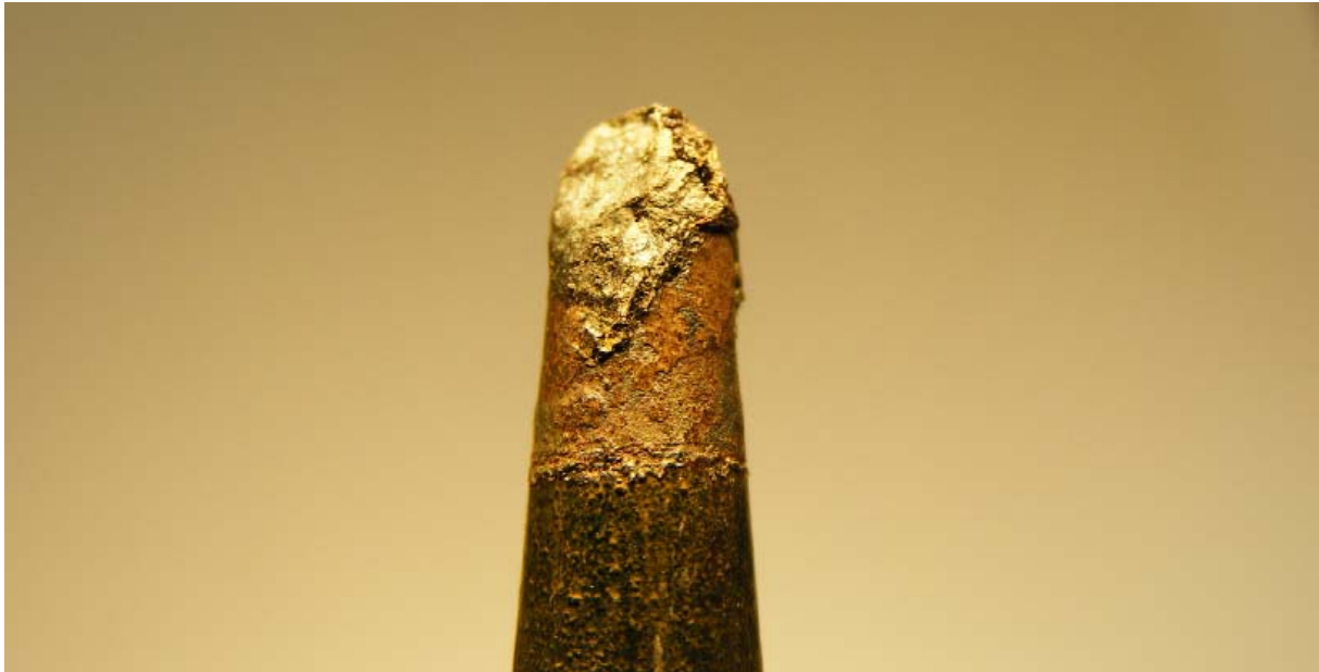
Bild: Kupferfraß einer Lötstelle
