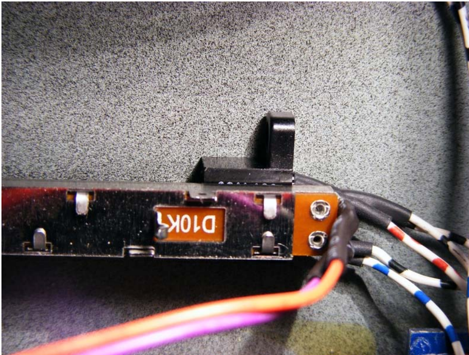
Bild: Eingesetzte Lichtschranke an den Fadern 1 und 2 der Mikrofonkanäle
