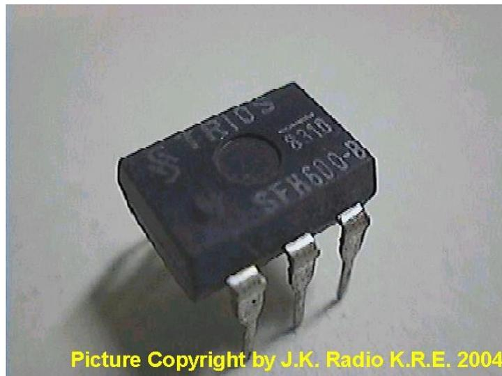
Bild2: Optokoppler SFH600, vergleichbar mit dem „Allerweltstyp CNY17“.
