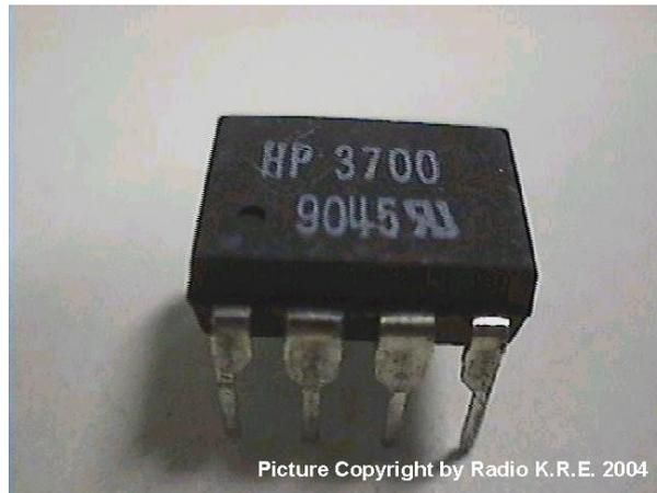
Bild21: Optokoppler HCPL3700 von HP mit integrierter Gleichrichterbrücke und Logikschaltung.
