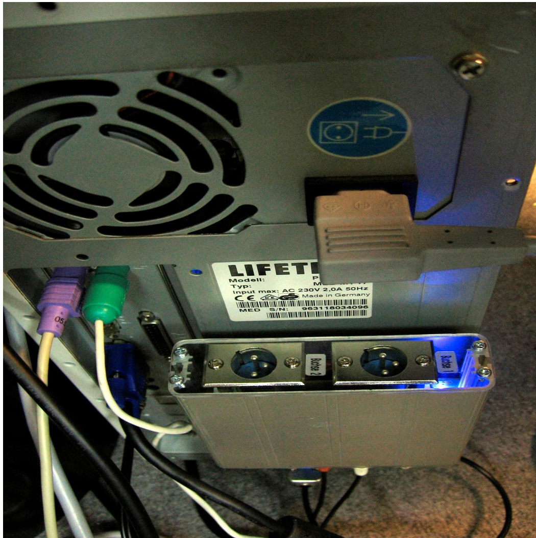
Bild: Wandler- und Symmetrierschaltung am PC Gehäuse. Ohne großen Aufwand wird die Soundkarte zum Sender der „symmetrischen“ Signale...
