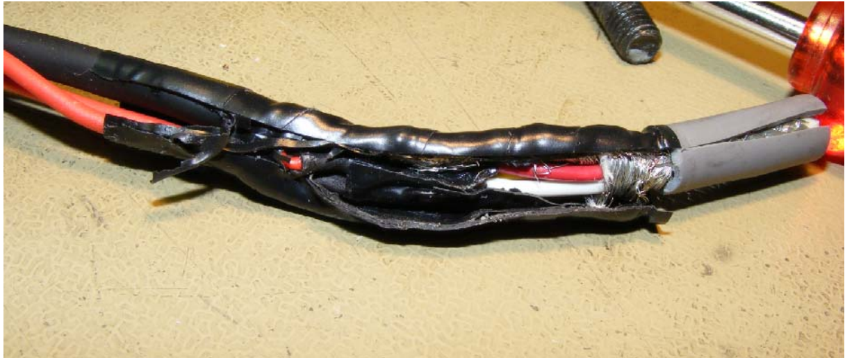
Bild: Geflicktes Kabel im Mikrofonarm
