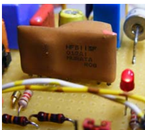
Bild: Leitungserkennung / Belegzustand der Telefonleitung
