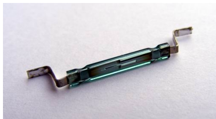
Bild: Reedkontakt im Glasgehäuse mit Edelgasfüllung
