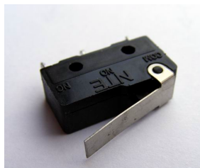
Bild: Mikroschalter für mechanische Abtastung von Bewegungen
