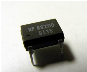
Bild: Von Hewlett Packard gibt es den HSSR8200 – der ebenfalls für Audioanwendungen bezüglich Signalschaltung geeignet ist.
