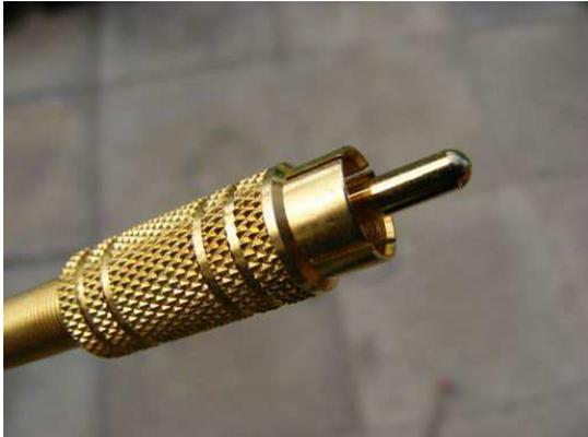
Bild: Typischer Cinch (oder Cynch) Steckverbinder – oftmals auch Phono oder RCA-Stecker genannt. Hier die vergoldete Ausführung, die kaum klangliche Vorteile bringt. Nur die verbesserte Kontaktgabe ist ein Pluspunkt für den Einsatz.
