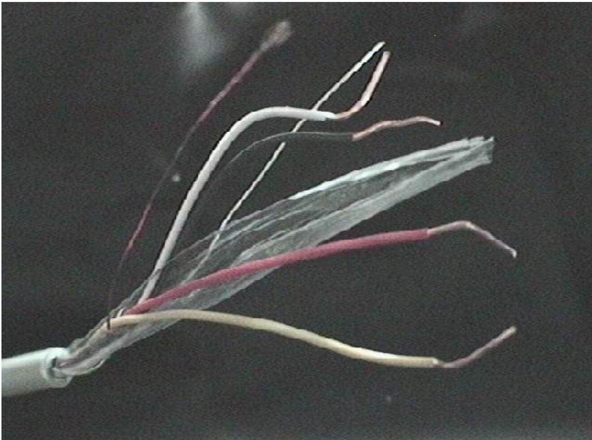
Bild1: Typisches Telefonkabel mit 2 Doppeladern
