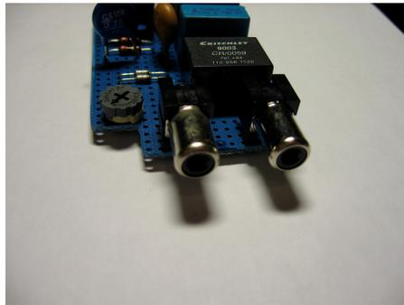
Das Ausgangssignal wird durch zwei Zener Dioden begrenzt, was bei hohem Signalpegel jedoch zu ungewünschten Verzerrungen führen kann. In diesem Fall ist vor den Telephone Line Adapter 2005 ein Widerstand zu schalten, der zwischen 560 Ohm und 1K Ohm liegt. Damit kann der maximale Leitungspegel angepasst werden. Zusätzlich kann mit einem Trimmer das Ausgangssignal eingestellt werden:
