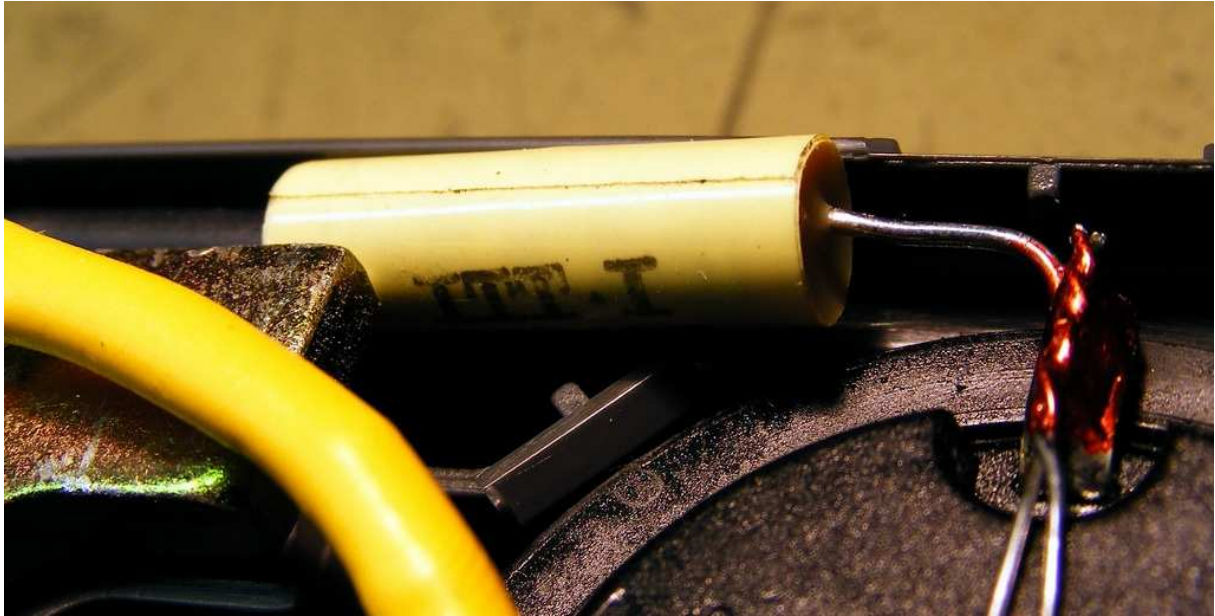
Bild: Ein bipolarer Kondensator koppelt die Gleichspannung ab, die eventuell an den Messspitzen liegen kann.
