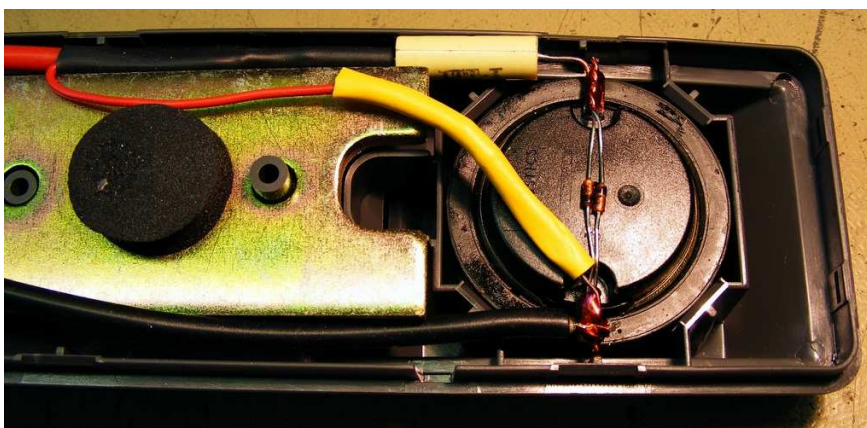
Bild: Innenaufbau des Testhörers. Gut zu erkennen sind die beiden Schutzdioden und der Koppelkondensator, der Gleispannungsfluss unterbindet. Zusätzlich sorgt er für eine ausreichende Mindestimpedanz des Testhörers.
